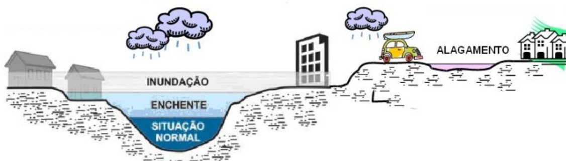
Figura 51- Alagamento, enchente, inundação
