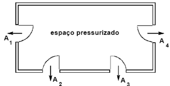
Figura 1 – Trajetórias de escape de ar em paralelo
