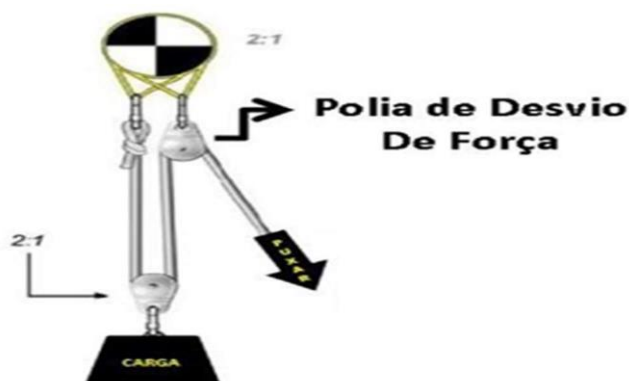
Sistema 2:1 com desvio de força
