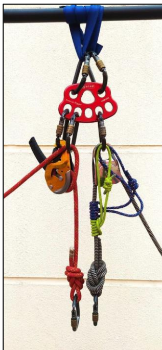
ID ponto fixo e equipado com mosquetão de reenvio
