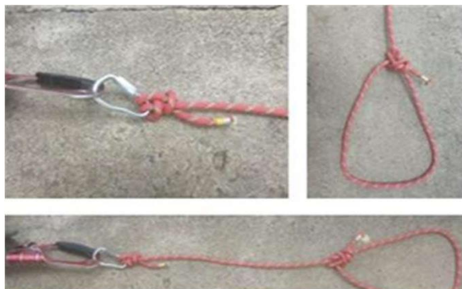
Montagem do estribo no ascensor de punho
