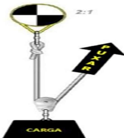
Sistema 2:1 sem polia de desvio de força
