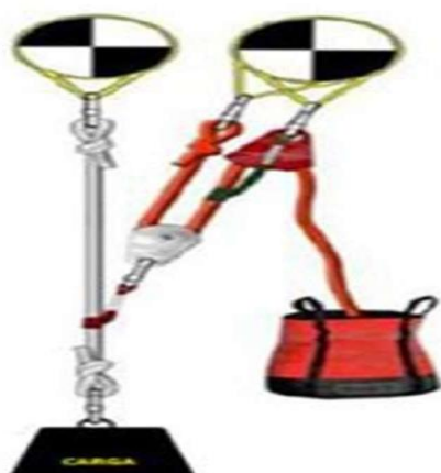
Sistema Independente 2:1, vertical
