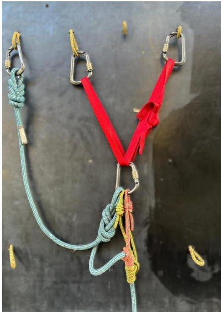
Ancoragem equalizável com dois e três pontos
