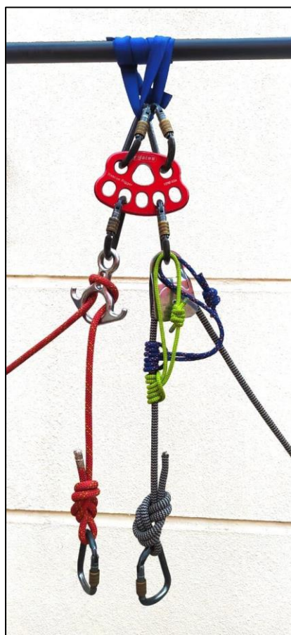
Sistema de “Oito Fixo” com backup
