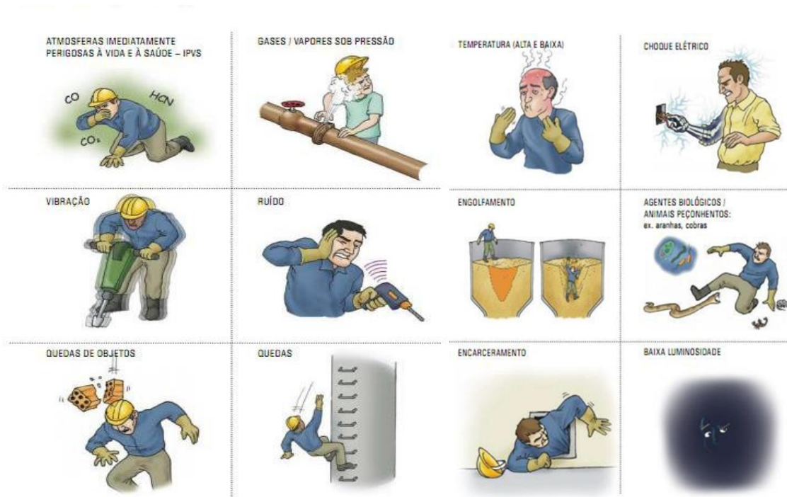
Riscos no espaço confinado
