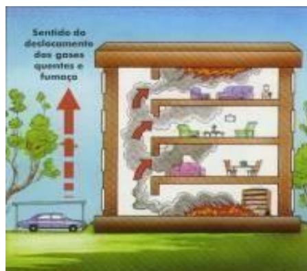
Figura 3.2.1 Indicando sentido de propagação da fumaça
