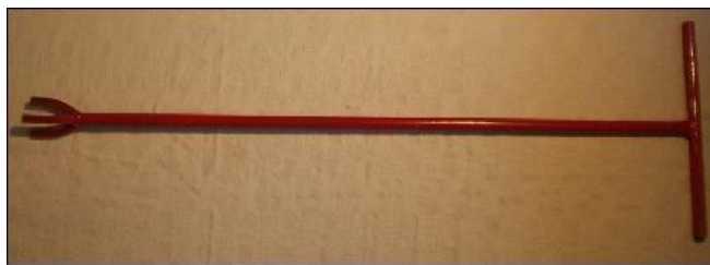
Chave de Hidrante tipo Volante
