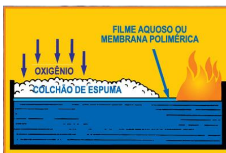
Esquema de atuação da espuma no incêndio
