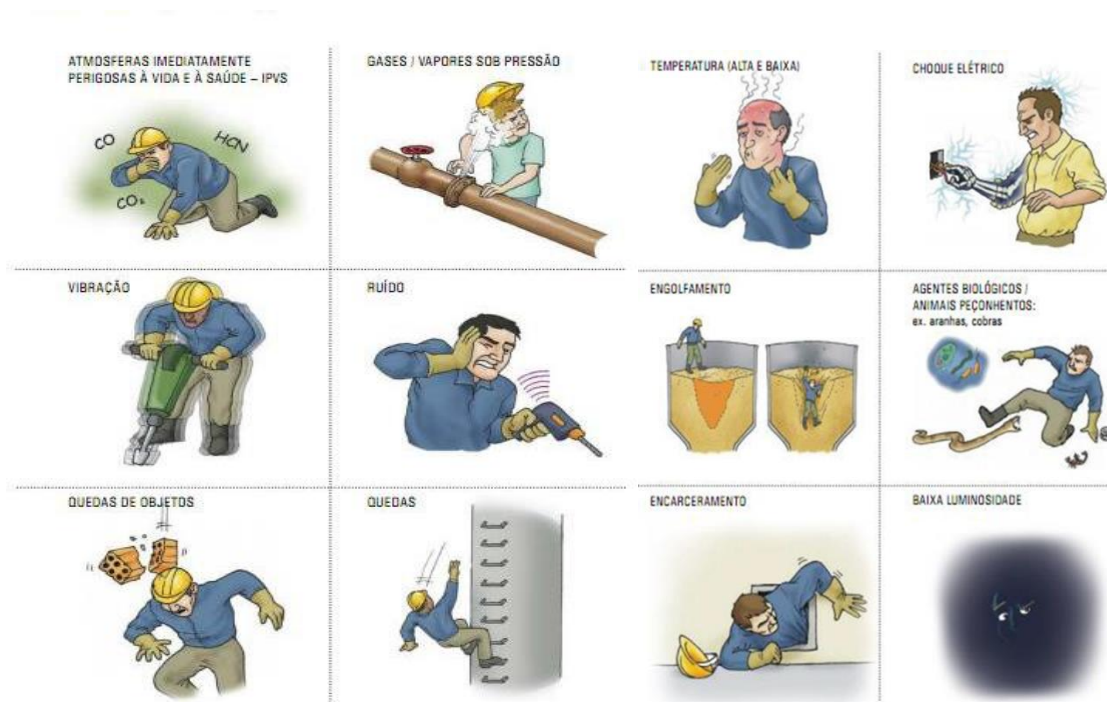
Riscos no espaço confinado
