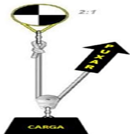
Sistema 2:1 sem polia de desvio de força
