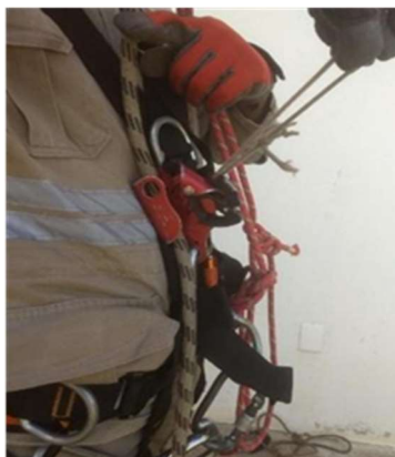
Colocação do ascensor de punho e ventral na corda
