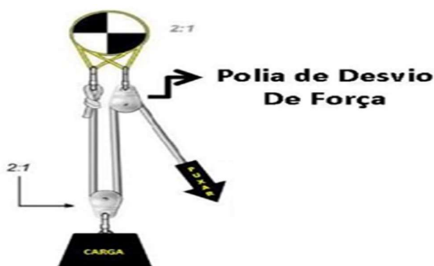
Sistema 2:1 com desvio de força
