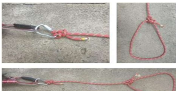
Montagem do estribo no ascensor de punho
