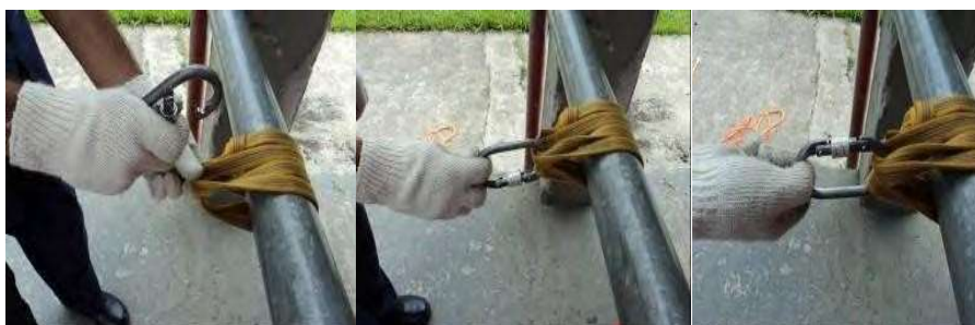
Fita dobrada em ponto fixo
