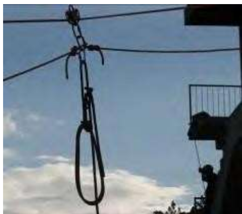
Balso pelo seio pronto para operação.
