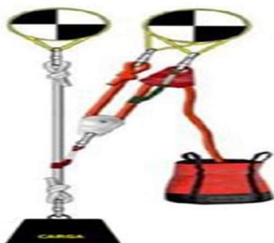
Sistema Simples Independente 2:1, vertical
