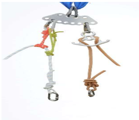
Sistema de “Oito Fixo” com backup
